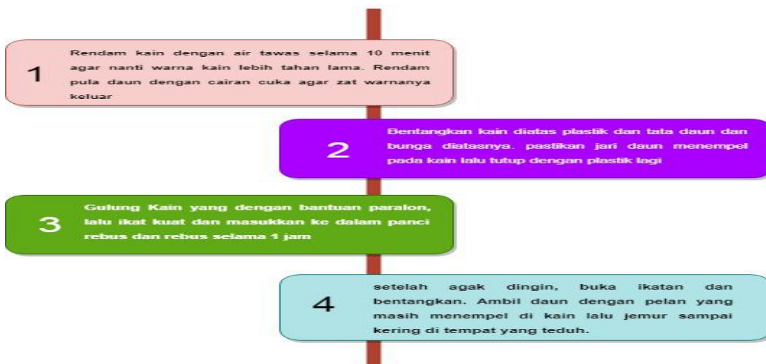
Gambar 2: Proses Pembuatan ecoprint dengan Teknik Rebus
